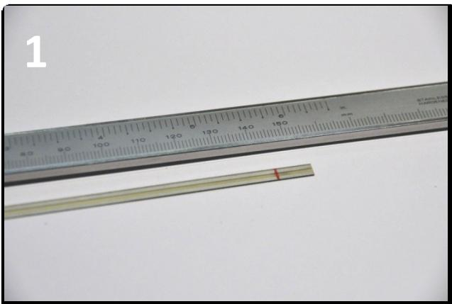
**DE** - Vergleichen Sie die Länge der Druckleiste mit dem verfügbaren Raum unter dem Dach (in diesem Beispiel 145 mm). Lassen Sie an beiden Seiten des Dachs jeweils 2-3mm Spielraum.
