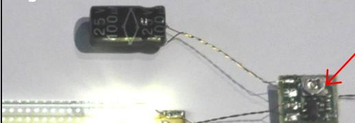
**DE** - Testen Sie die Funktion der LEDs, indem Sie eine Stromquelle an die Versorgungsplatine anschließen. Indem Sie mit einem kleinen Schraubenzieher am Potenziometer drehen, stellen Sie die Helligkeit ein.
