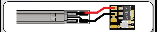
**DE** - Schließen Sie die Versorgungsplatine an. Vergewissern Sie sich, dass Sie das rote und das schwarze Kabel an den richtigen Stellen anschließen.
