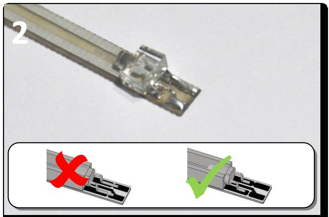
**DE** - Drücken Sie die LED auf der Anschlussseite auf die Druckleiste. Achten Sie darauf, dass der unterste Fuß niemals die Anschlusspunkte für die Kabel berührt. Löten Sie die Füße der LED fest auf die beiden Inseln der Druckleiste.
