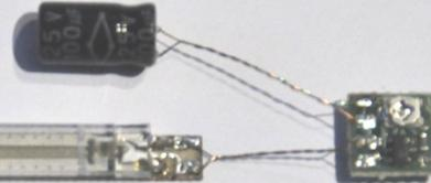
**DE** - Schließen Sie die mitgelieferte Kondensator an. Diese schränkt das Blinken während der Fahrt ein. Beachten Sie die Polarität der Versorgungsquelle!
