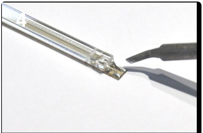
**DE** - Montieren Sie die zweite LED an der Abschnittsseite und drücken Sie sie fest auf den Lichtleiter. Löten Sie die LED anschließend auf die beiden Leiter der Druckleiste.
