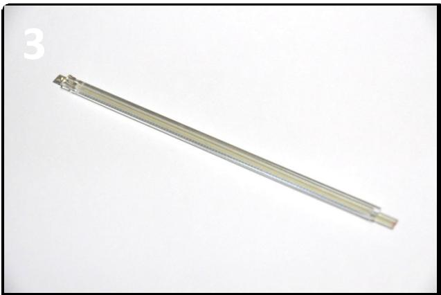
**DE** - Drücken Sie den Lichtleiter an der Anschlussseite gegen der LED. Für eine optimale Lichtverteilung muss sich die Einkerbung im Leiter über die gesamte Länge an der Unterseite befinden.
